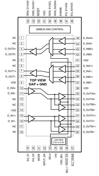
Figure 1. DS100MB203 Pin Diagram 54 Lead
